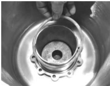
**Paso 14:** Instale el O-ring nuevo en el cople, asegurándose que se asiente totalmente en el ranura de la brida de acero inoxidable.
