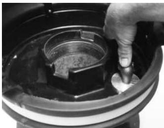
**Paso 9:** Lubricar el adaptador de dren e instalar en la cavidad de drene. Asegúrese de que el adaptador está correctamente asentado y al ras de la base del contenedor de derrames.
