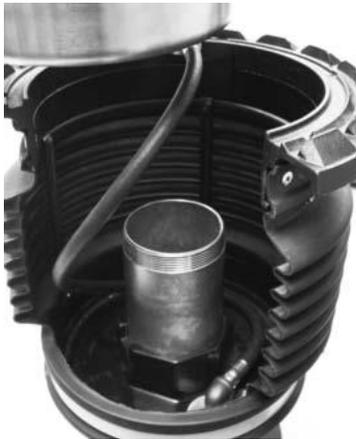
**Paso 13:** Conecte un extremo de la manguera a la conexión de la manguera y el otro extremo a la parte inferior del casquillo. De vueltas al casquillo de acero inoxidable para la acomodar la manguera en sentido opuesto a las manecillas del reloj con la orientación que se muestra, aproximadamente 1 1/4 de vueltas. Si el nuevo casquillo interfiere con la manguera, girar ligeramente en el espacio libre apropiado.
