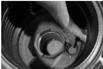
**Paso 7:** Con una llave de 1/2 ", quitar el dren, si lo hay. Cuidadosamente inspeccionar la cavidad de drene para garantizar que no hay ningún daño que pudiera causar que el casquillo falle los requisitos de prueba. Limpiar la cavidad de drene.
